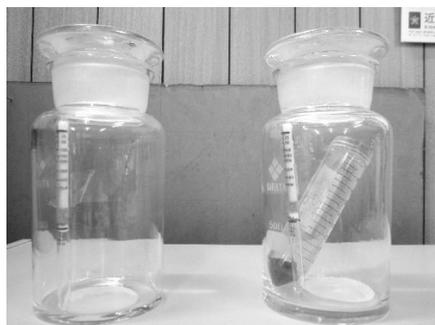
写真3 ガラス試薬瓶内に発生したアンモニアガスの測定実験（右：対照区、左：炭設置区）
