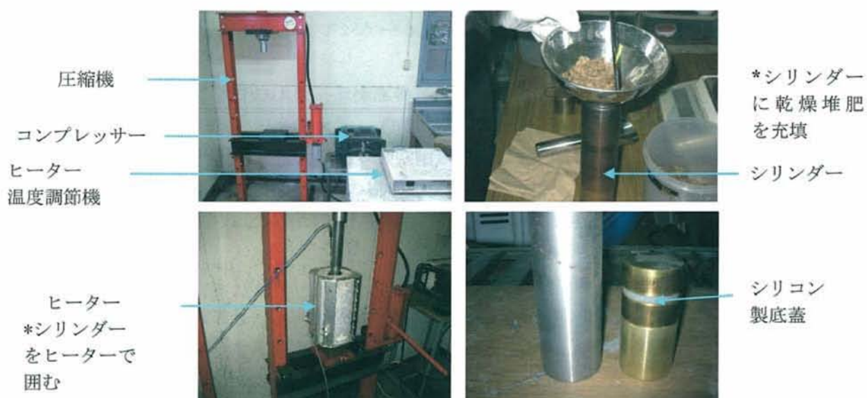
第10図 堆肥を利用したバイオコークスの作製方法
