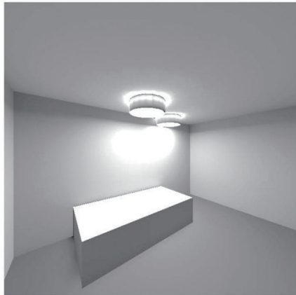
器具設置イメージ 設定反射率:天井50% 壁30% 床10% 器具下面透過率50%
