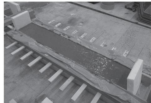
図4 引張試験体型枠（上）とモルタル充填直後
