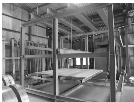
写真 4 鉛直載荷試験体設置状況
