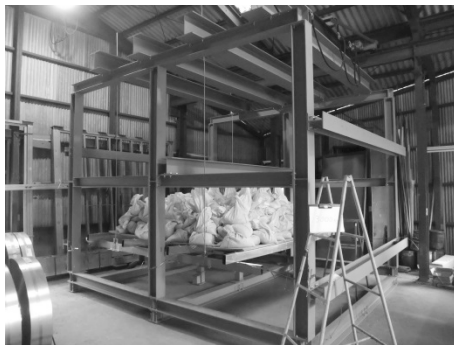
写真 5 最終荷重状況 (総積載重量 3000kg 時)
