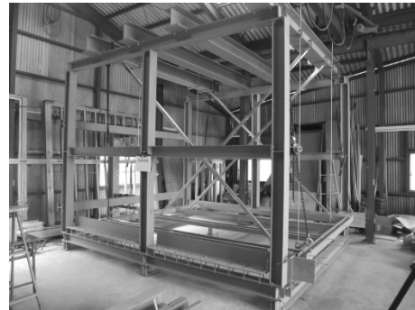
写真 6 耐震吊り天井の水平加力試験体設置状況
