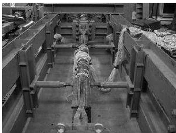
写真1 引張・圧縮静的繰り返し加力装置
