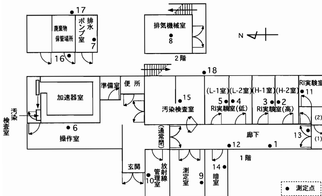
第3図 トレーサー・加速器棟における $\gamma$ 線量率測定点
