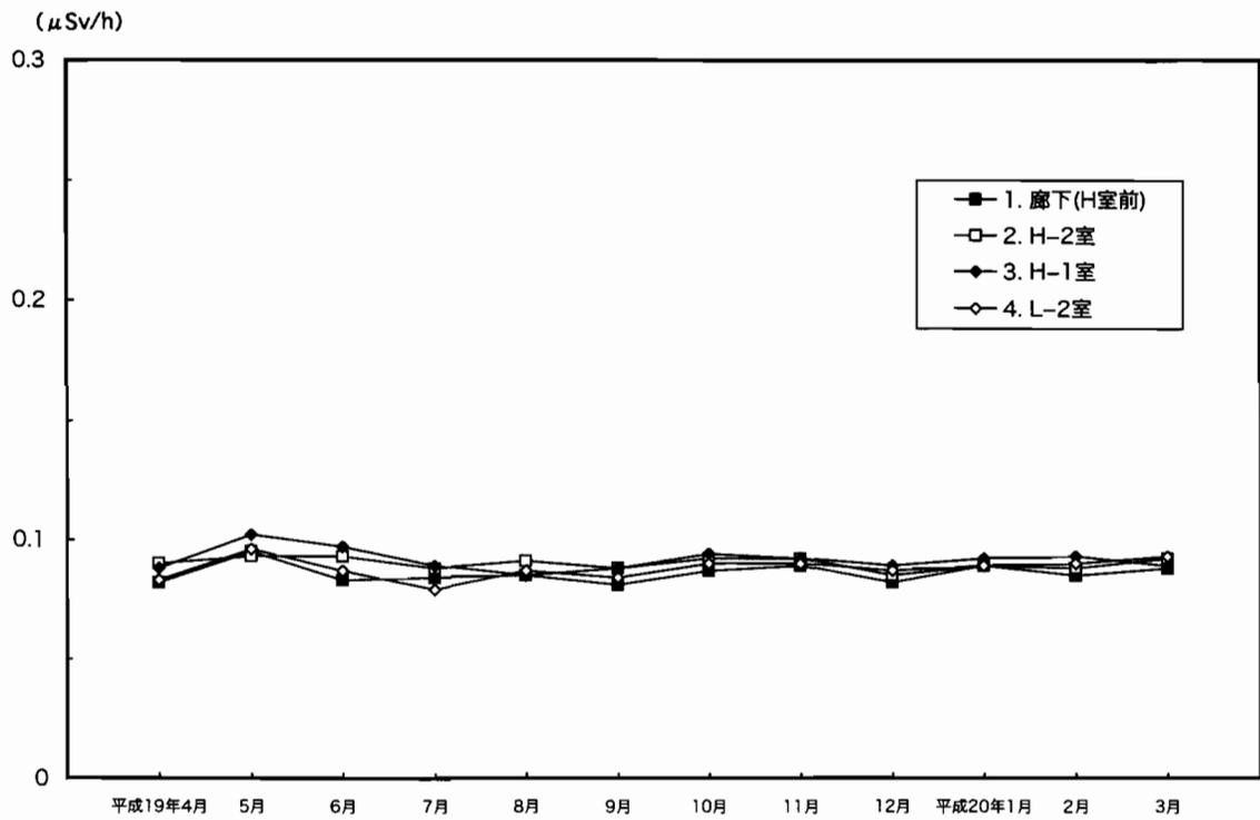
第4-1図 トレーサー・加速器棟における月間平均γ線量率の変動
