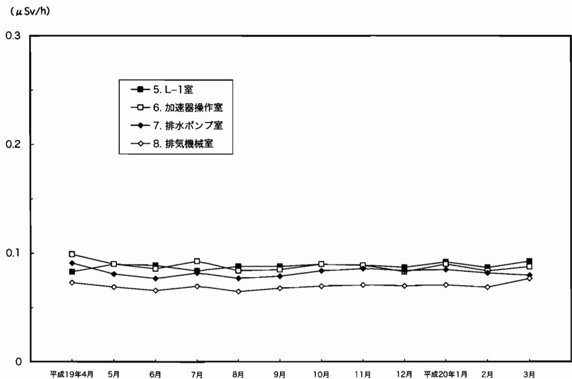
第4-2図 トレーサー・加速器棟における月間平均γ線量率の変動
