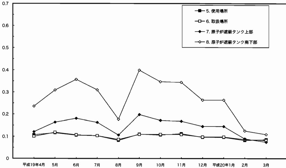
第 2-2 図 原子炉施設における月間平均  $\gamma$  線量率の変動
