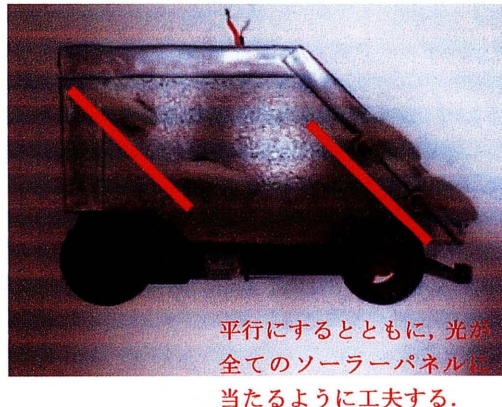
図 4 ソーラーパネルの設置角度
