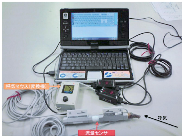
図5 パソコンにUSB接続した呼気マウス
