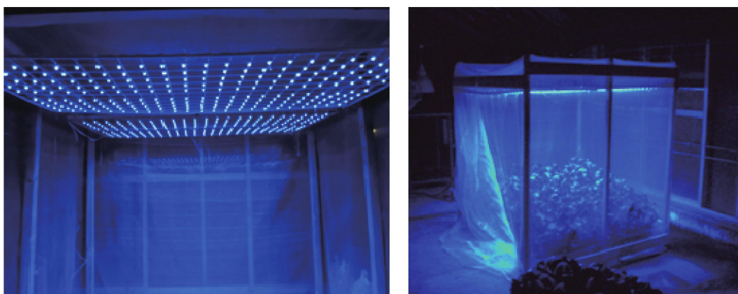
図 1 作成した LED パネル(左)と照射装置の外観(右)
