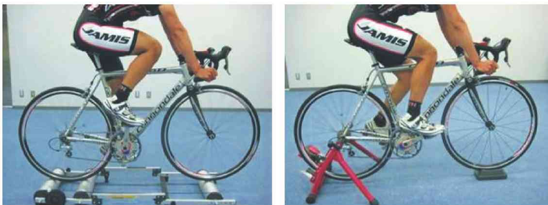
左がフリー式ローラー (AC-MAGROLLER, MINOURA 社, 日本), 右が固定式ローラー (RDA80 Rim DriveAction, MINOURA 社, 日本). ともに 60rpm の条件で 250w の仕事率となるように負荷の設定を統一した.
