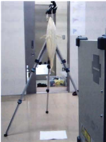
Fig. 1 3次元デジタルライザを用いたクロマグロの魚体形状測定
