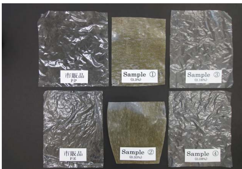
図-6 グリーンプラスチック袋の分解実験経過の様子
