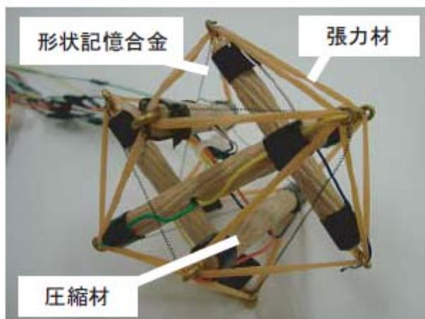
図 1 テンセグリティ型移動ロボット
