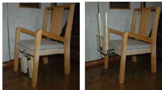
椅子型脚伸展筋力トレーニングマシン 試作機
