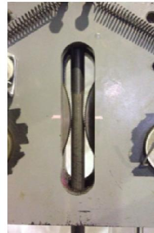
(4)実験3 長鋼棒2軸加力実験 前述の実験1で筋違材として用いた鋼棒と同じ径・材質で長さ約2mとした鋼棒を試験片とする。
