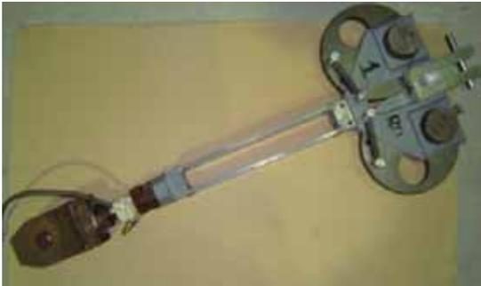
(2)実験2-2 大径偏心輪実験 支圧力比を  $\lambda = 2.0$  とし、偏心輪には直径を200mmの真円から切り取った三日月形とするチャックバックルを試作し(下の写真) これを前述と同じ鋼製架構に組み込んだ場合の復元力特性を求め。
