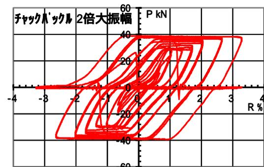
この実験では、R が 3 % の第 1 サイクルを経験したところで筋違鋼棒が左下がりと右下がりの両方で破断し、P が急激に低下していた。つまり、目標としていた R = 6 % に達することはできなかったが、しかし破断するまでは、P - R 曲線に見るとおり、紡錘型の履歴ループを描いていることが分かる。最大荷重が 40kN となっているが、これは筋違鋼棒の引張り降伏点に対応する水平荷重値である。
