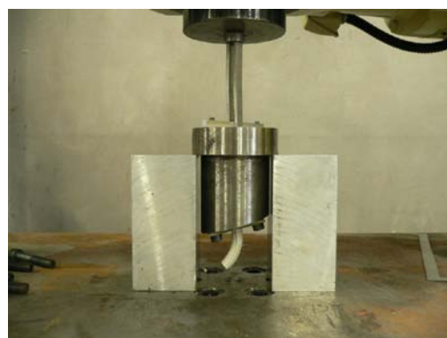
図2 押し時の素材の変形
