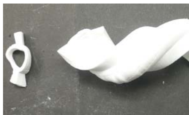
図4 押し出し後の軟質ポリ塩化ビニル製フィンチューブ
