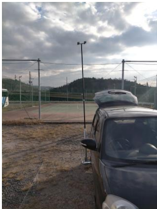
図7. TYRodに簡易ステレオカメラを取り付けた様子
