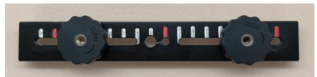
図5. アルミニウム合金製のデュアルカメラプレートを示す。三脚の雲台と接続する中央のネジ位置と、そこから左右にそれぞれ80mm 離れたカメラ取り付け位置に、フライス盤を用いて目印をつけた。
