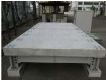
図2 模擬床版試験体
