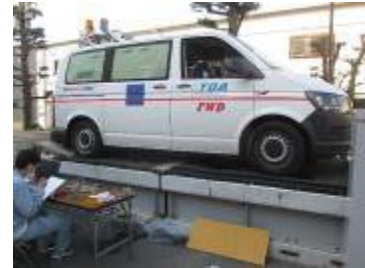
図4 FWD 試験状況
