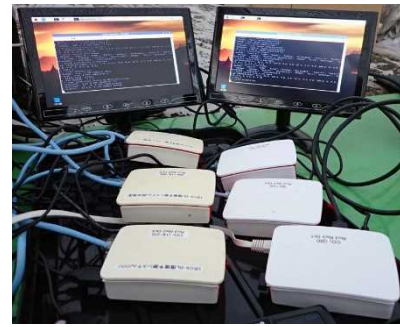
図6 供試温室での 3 年分・1 年分×気温・相対湿度・CO 2 濃度の 6 台でリアルタイム予測テスト
