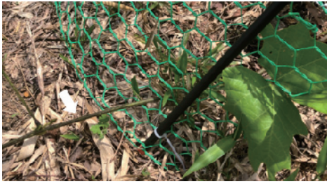
図6. パルス型アーク放電発生型フェンスの網目を通過するクズ（白矢印）
