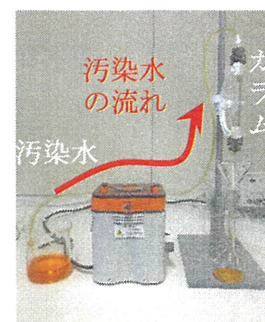
Fig. 2. カラム型フロー式浄化方式視認性をあげるために汚染水を着色。実際は無色透明。
