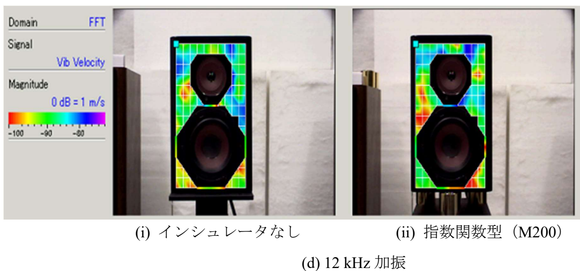
図 5-10 スピーカバツフルにおけるにおける振動速度レベル分布の比較 (つづき)
