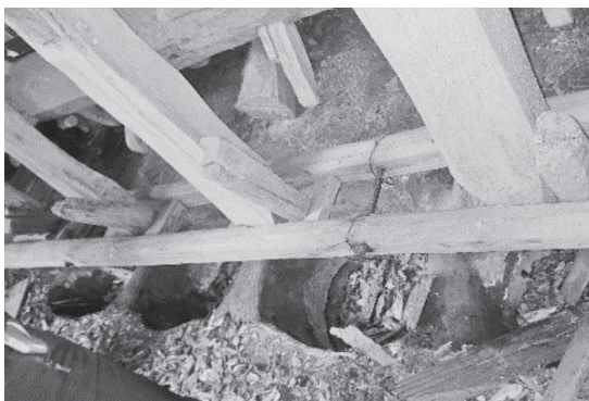
写真5 縦杵(ドウツキ)(横杵よりも強い力で粉を搗いた。)(2020年撮影)
