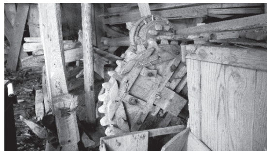
写真6 篩（右）に接続する木製のギア（複数の木片を合わせて造られている。）（2020年撮影）
