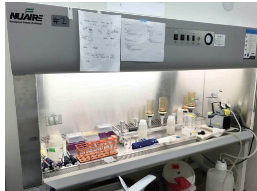
下水を使った実験を行うために BSL2実験室内に設置された安全キャビネット
