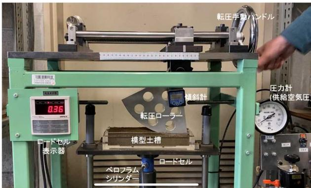
写真-1 転圧模型試験機
