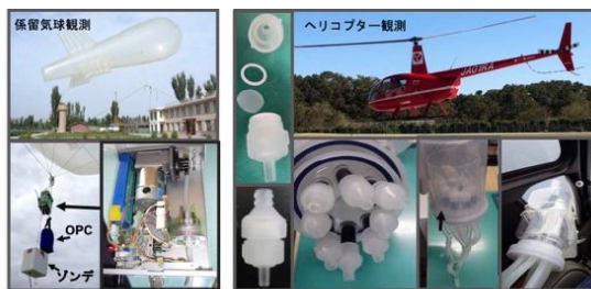
図3 係留気球(左)とヘリコプター(右)を使った高高度大気観測
