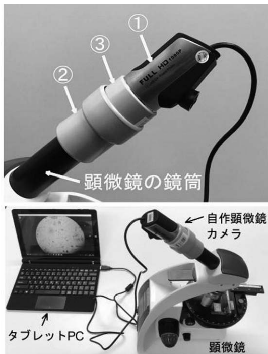
図1 自作顕微鏡カメラの構造（上）とタブレットPCとの接続（下）
