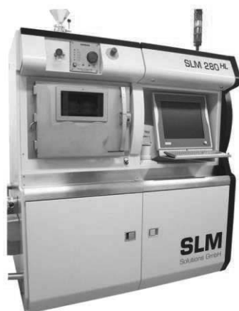
図 2 導入した金属 3D プリンタの外観
