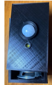
図 5 超音波(左)と高出力 LED(右)による追い払い装置
