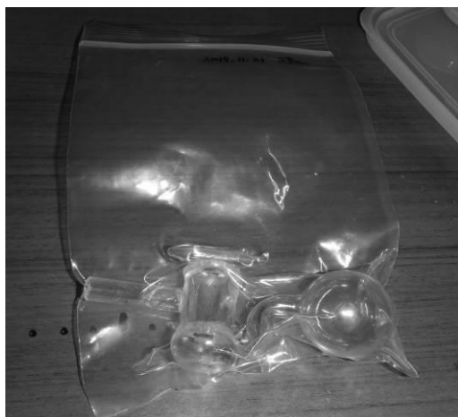
図1. 照射用の石英ガラス容器の外形
