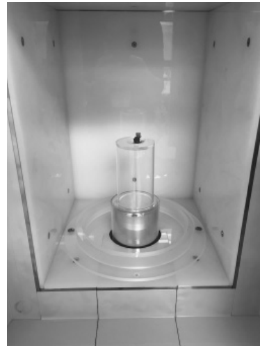
図3 測定試料設置内の様子。垂直型クライオスタットから突出している検出面と特定の検出面と測定場所との距離 (本研究では、10 cm の距離を基準とした。) を保持する特注スペンサーが中央に見える。
