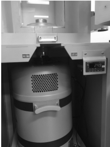
図2 ポップトップ型の検出部を鉛遮蔽体で覆い被した専用シールド架台 (デュワー部も化粧する囲いもある) が組み、かつ電気冷却と液体窒素冷却併用式 Cryo-Cycle II (クライオサイクル) を搭載した新しい HPGe 検出器の外観を表している。
