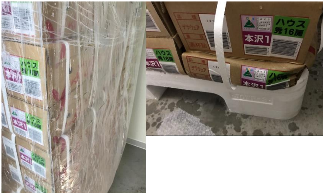
図 2-17. フィルム内の結露の状態（左）とそれに伴う段ボールの潰れの発生（右）
