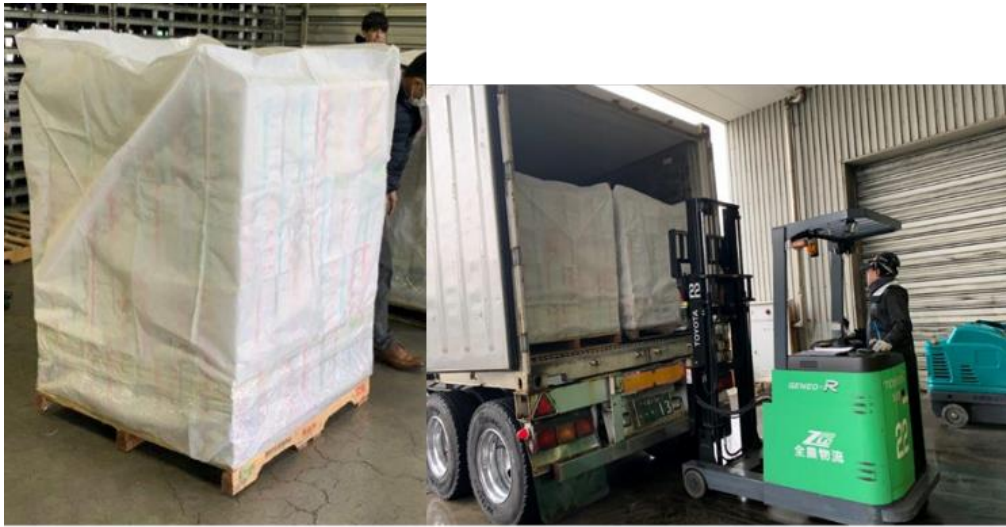
図 1 -31. MAパレット処理後の状態（左）およびコンテナへの積載作業（右）
