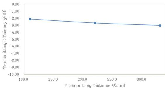
図 21 共鳴コイル敷き詰めによる伝送効率計測実験結果
