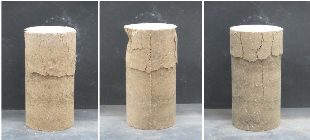
写真 3.5.1 セメント濃度の違いによる供試体表面の色（左から 5, 10, 15%）
