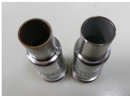
図2 真空計測定子 (ULVAC M-11) 左：2年間ほど使用したもの 右：新品
