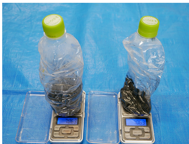
図3 : 空気並びに酸素をペットボトル内で反応させた後の秤量。(左図) 空気を充填;(右図) 酸素のみを充填
