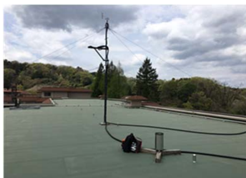
写真3. 研究棟屋上の観測塔（風向・風速・日射量・雨量）
