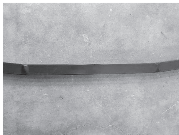
写真 8 試験体の終局状況 (□45×45×0.8・連続体)
