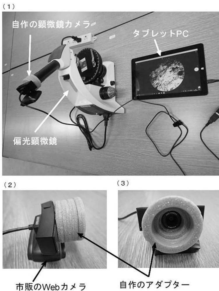
図4 自作の顕微鏡カメラとタブレット PC の接続法(1) および自作の顕微鏡カメラの側面(2)と正面(3)の拡大写真
