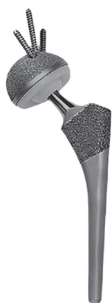
図6. セメントレス THA インプラント (Kyocera, Japan). カップとステム近位部にポーラスコーティングが施されている。
