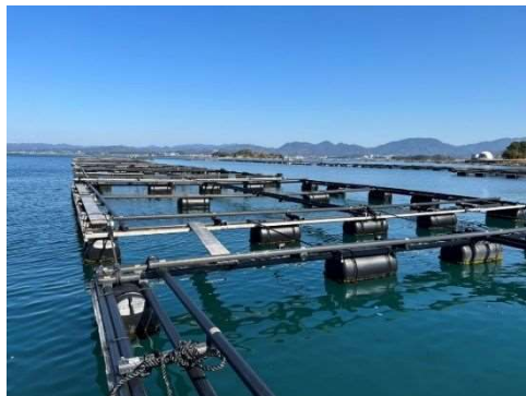
図 1：現在の主流となっている FRP 製生簀と高密度ポリエチレン製フロート
