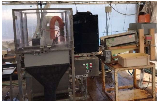
図 6: 現在開発中の自動選別システム（黒いボックス内で通過する稚魚を画像解析し、除外すべき稚魚は後方のロボットアームで除去する）
