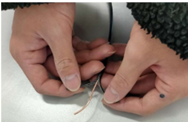
図6. ミシン目が入った被覆を剥ぐ工程
