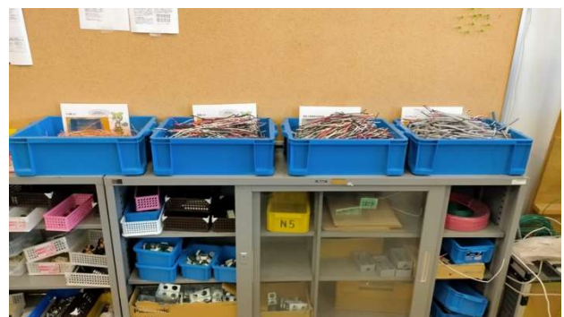
図9. 工程ごとに分類されたケーブル
