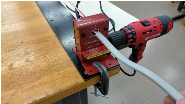
図4. トリッパーIVを用いたVVFケーブルの割線
