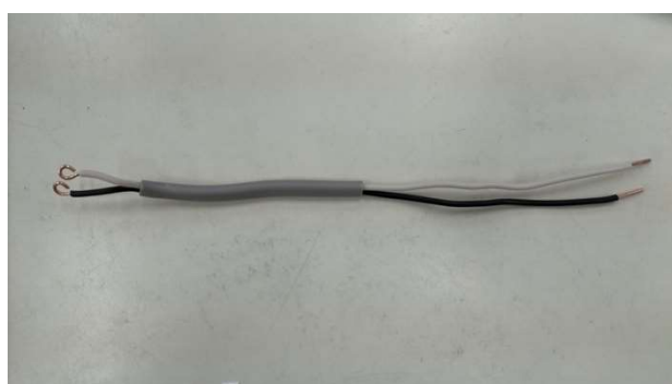
図 3. 輪作りされた VVF ケーブル
