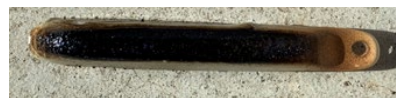
図3 基材背面に耐火レンガを設置して製作した那智黒溶射皮膜の状態
