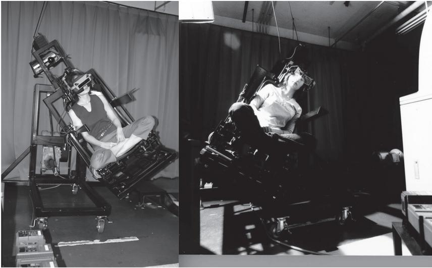
図7 地上実験で必要だった装置3：多軸（3軸）スイング椅子
