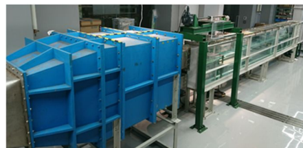
図1. 風波水槽の(左図)概略図、(右図)写真
