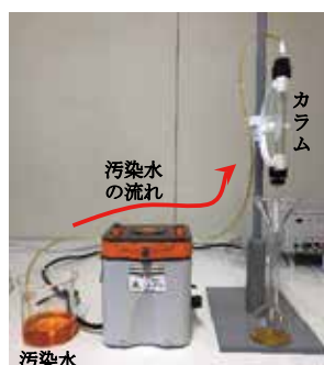
Fig.1. カラム型フロー式浄化システム
