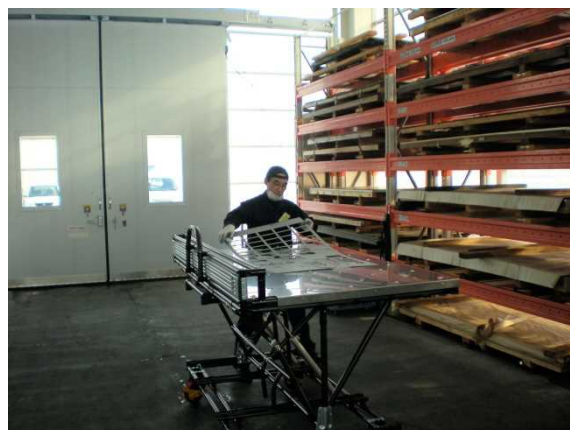
図 3.38 自動扉の設置と移動式専用台の製作
