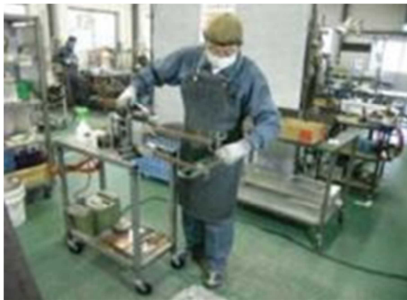
図 3.45 スポット溶接作業
