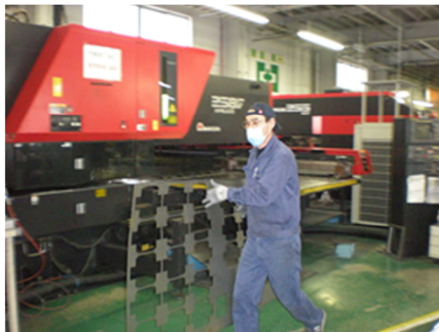
図 3.35 端材運搬作業
