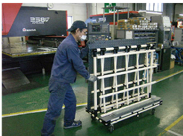
図 3.36 端材・廃材運搬用の三角台車
