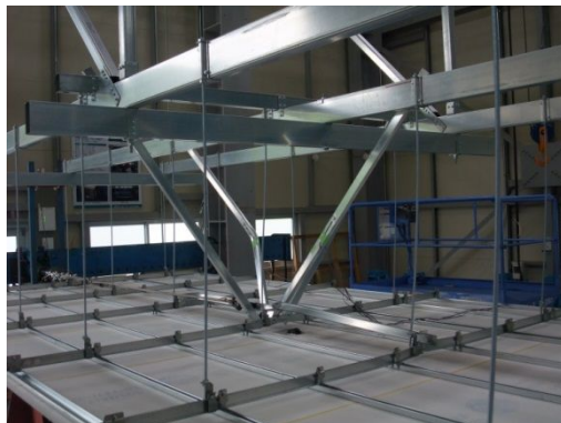
写真5 モデル5の終局状況 (斜め材の座屈)
