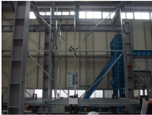
写真 6 モデル 7 の終局状況 (部材の座屈)
