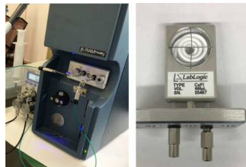
図 2 水へのトリチウム透過量測定装置の外観写真
